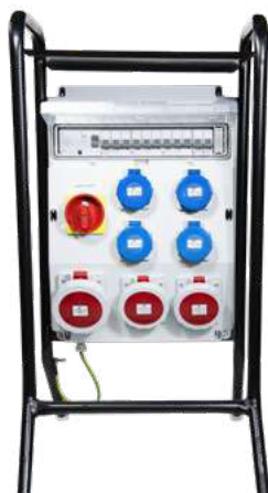
Staveništní rozváděč EDS16S RCD 4/3 16/32/VYP 3430 Krytí: IP66 s hlavním vypínačem 63A v uzamykatelném provedení
